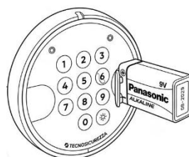
3. กรหัสเปิด แล้วเปลี่ยนแบตเตอรี่ด้านในเซฟ
