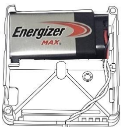
5.ใส่แบตเตอรี่กลับสายไฟ
